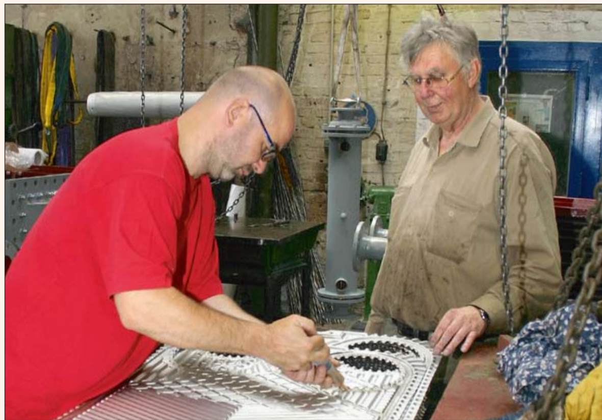
Hier werden Platten-Wärmetauscher repariert
